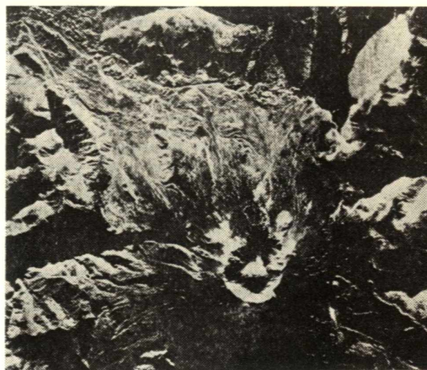
Stále širší použití v dálkovém průzkumu Země mají radarové techniky, které umožňují získávat mimořádně plastický obraz terénu. Tím, že radarové vlny mohou pronikat vrchními vrstvami půdy nepokryté vegetací, ukáží skutečný stav pevného podloží, ukrytého pod nánosy erodované horniny až do hloubky 6 m. V centru snímku je vulkán St. Helene. Rozlišovací schopnost záběru je 6×6 metrů. Foto archiv
