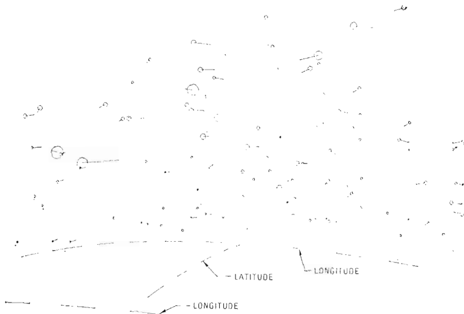
Obr. 5. Počítačem vytvořený pohled na oblohu, zaznamenávající umělé družice, jak by se jevil pozorovateli ve výšce 550 km, v šířce 35° N, při pohledu na východ. Zorné pole je 30°×50°. Velikost kroužku je měřítkem vzdálenosti objektu a délka úsečky značí pohyb za 10 sekund. (Podle Chobotova)
