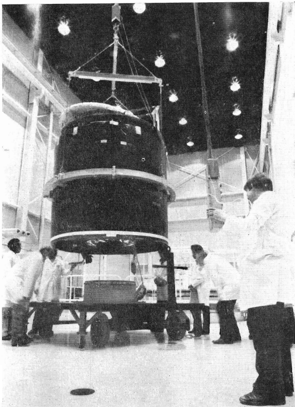
Kanadská družice Anik-D, sloužící státní společnosti Telesat. — Na 4. str. obálky je konstrukce HS 376, tentokrát v úpravě SBS. Družice je připravena v letové konfiguraci pro závěrečné zkoušky v simulátoru kosmických podmínek. (K článku na str. 157—161.)
