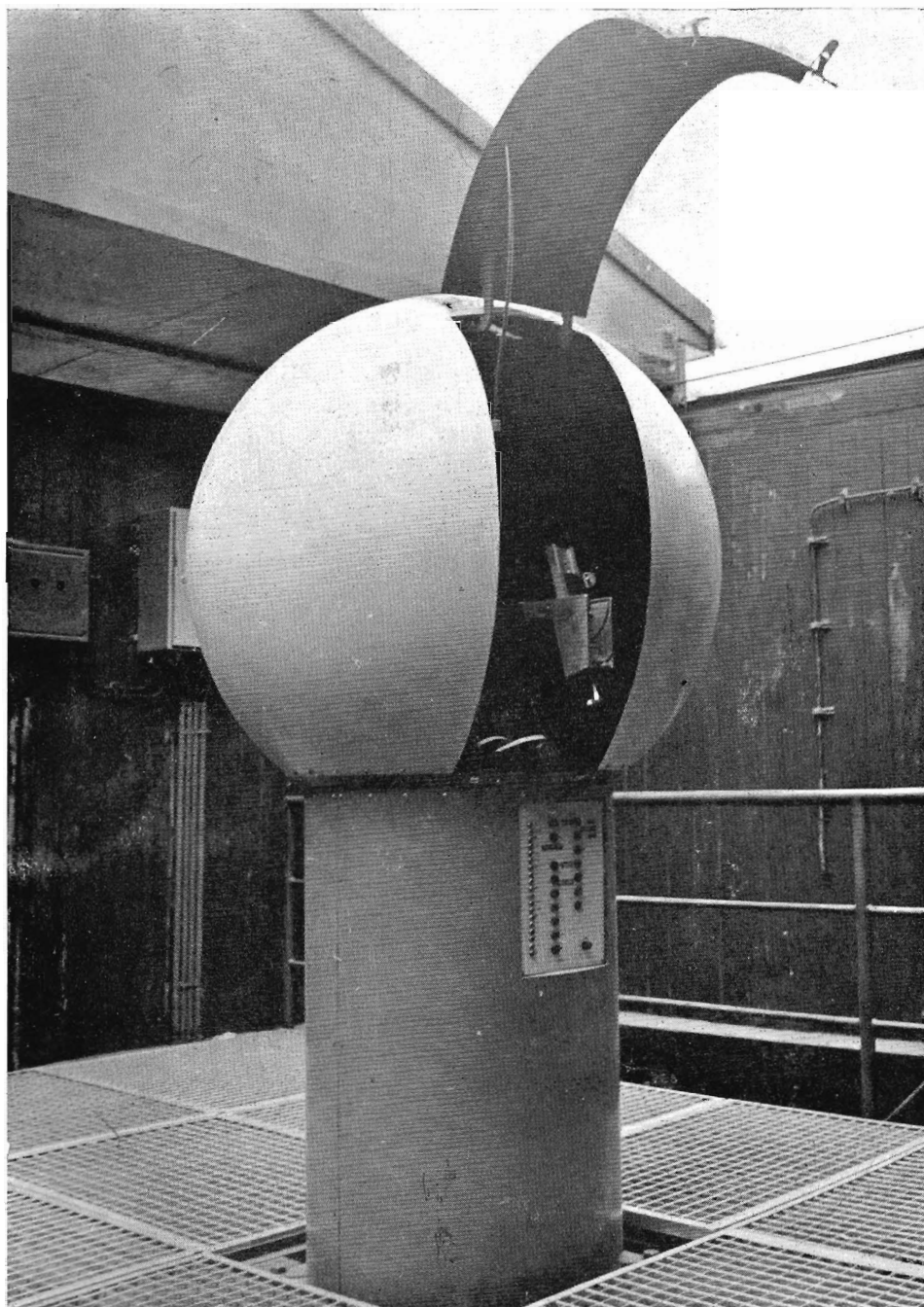
Fotografický zenitteleskop firmy Zeiss 250/3780 mm ondřejovské observatoře.
