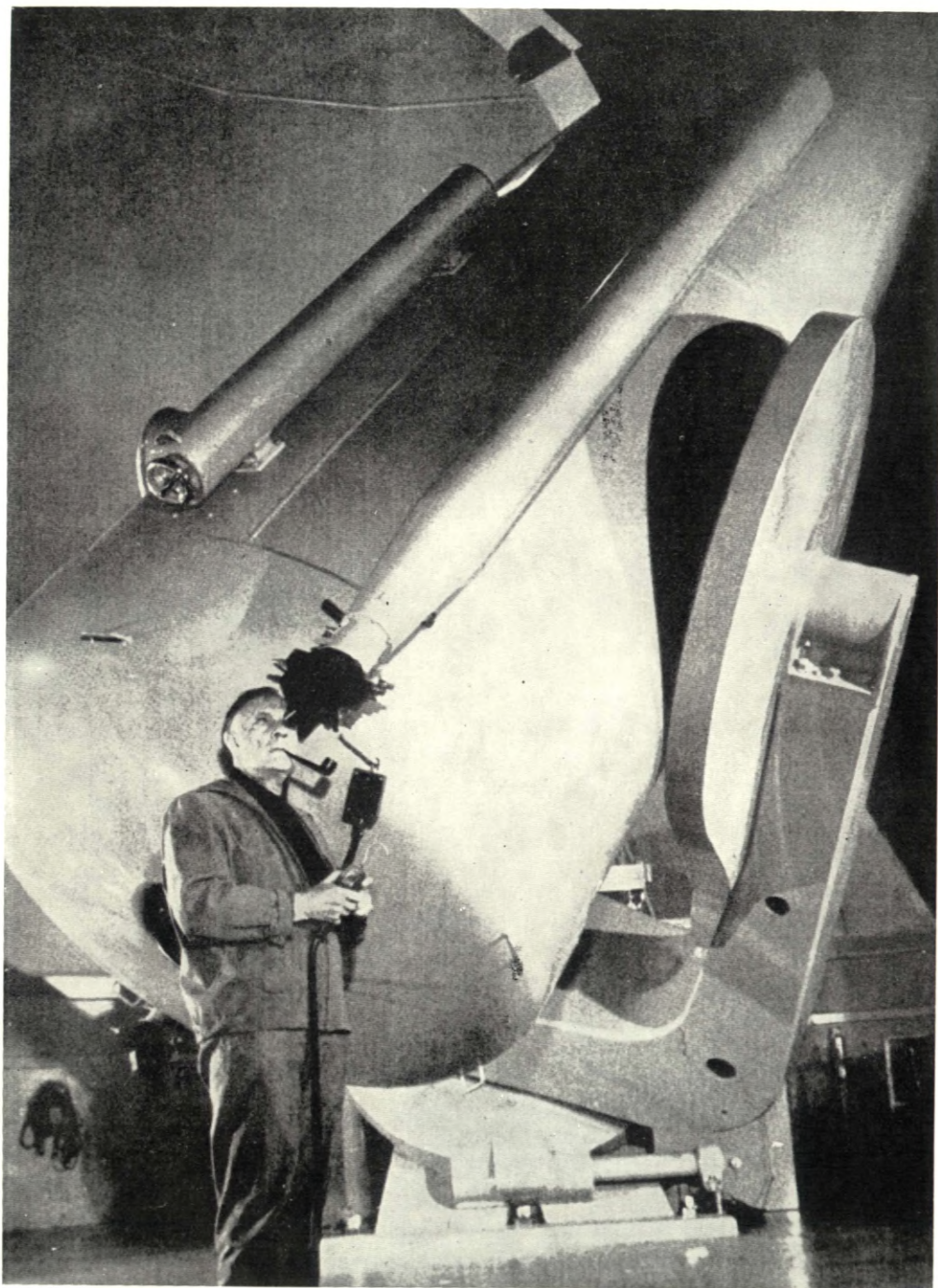
Velký Schmidtův zrcadlový dalekohled na Mt. Palomaru. Průměr korekční čočky 122 cm, průměr kulového zrcadla 180 cm, světelnost 1:2,5. U dalekohledu E. Hubble. — Na čtvrté str. obálky je Schmidtův dalekohled hvězdárny v Hamburku-Bergedorfu s korekční deskou o průměru 134 cm a zrcadlem o průměru 200 cm. Ohnisková vzdálenost je 4 m, velikost zobrazeného pole asi 5^\circ na desce 24 cm X 24 cm. (Dalekohled je nyní demontován.)
