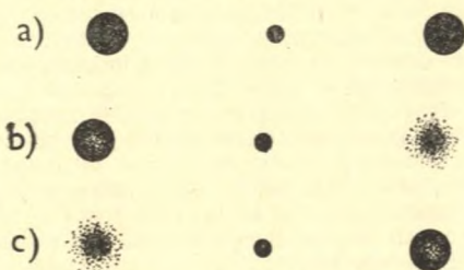
Obr. 16. Zářičí bod při okulárové zkoušce: (a) u kulového zrcadla, (b) u zrcadla se zdviženým okrajem nebo u zploštělého elipsoidu, (c) u zrcadla se sníženým okrajem nebo u hyperboloidu. Obrazy vlevo při posunu okuláru k zrcadlu, upravo od zrcadla, uprostřed při optimálním zaostření.
