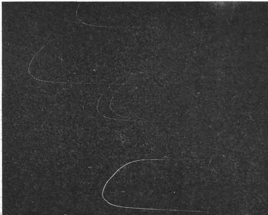
Obr. 2. Stopy hvězd v souhvězdí Oriona, fotografované kamerou Nikon F při letu rakety 29. února 1968. Tyto stopy dávají informaci o okamžité orientaci teleskopu vzhledem k obloze.
