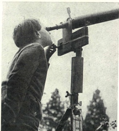
Jednoduchá montáž dlouhoohniskového dalekohledu podle Hevelia (foto I. Šolc).
