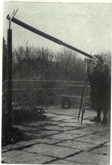
Jednoduchá montáž dlouhoohniskového dalekohledu podle Hevelia (foto I. Šolc).
