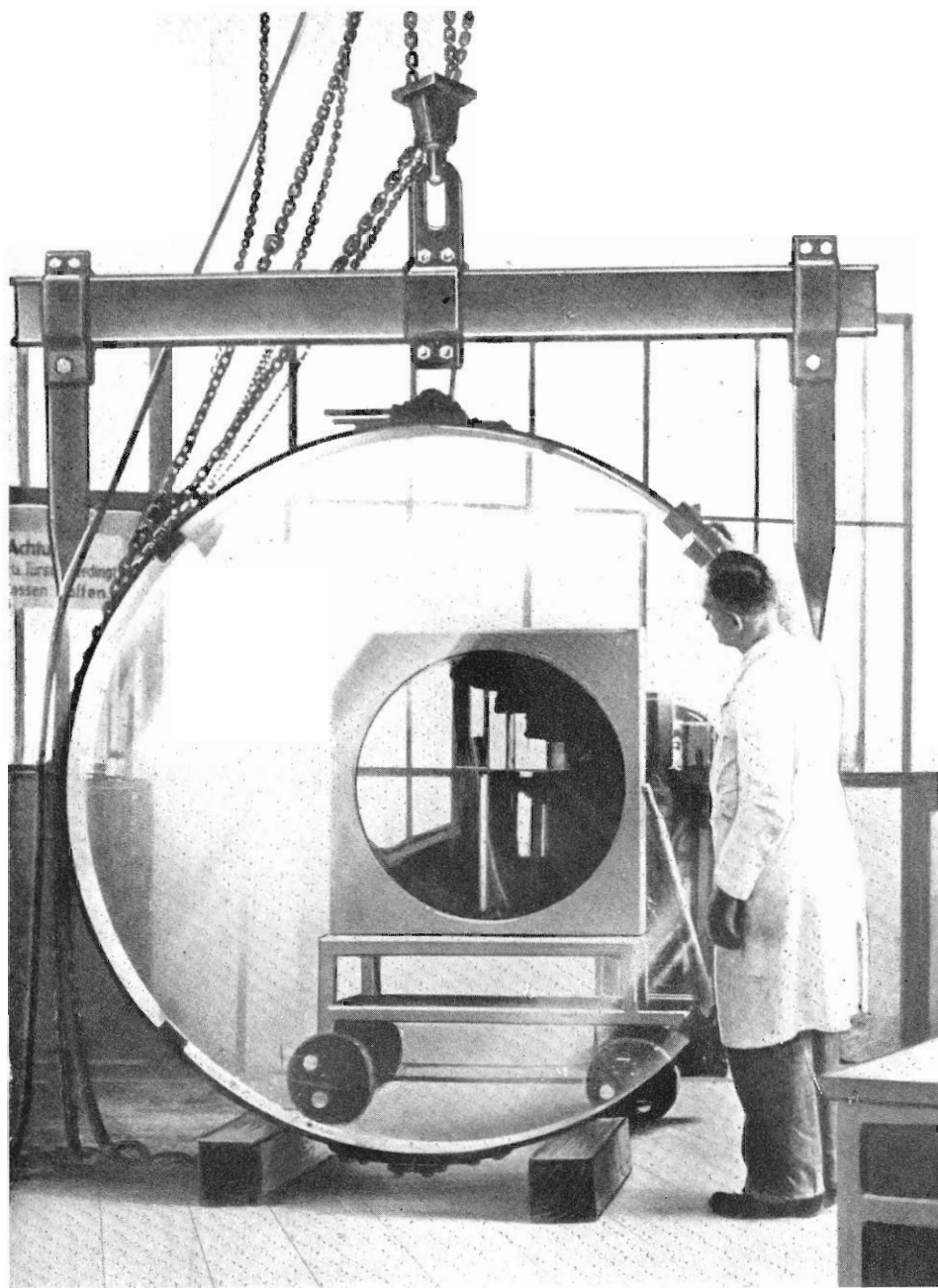
Zkoušení hlavního zrcadla dvoumetrového dalekohledu v polarizovaném světle (Reprodukce původních fotografií se svolením Zeissových závodů v Jeně)
