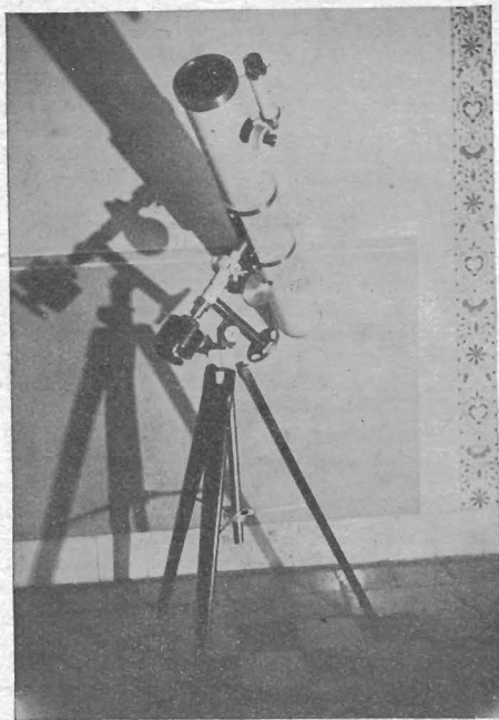
Dokonalý amatérský reflektor s hlavním zrcadlem o průměru 100 mm a ohniskové délky 1000 mm, sestrojil J. Küller.
