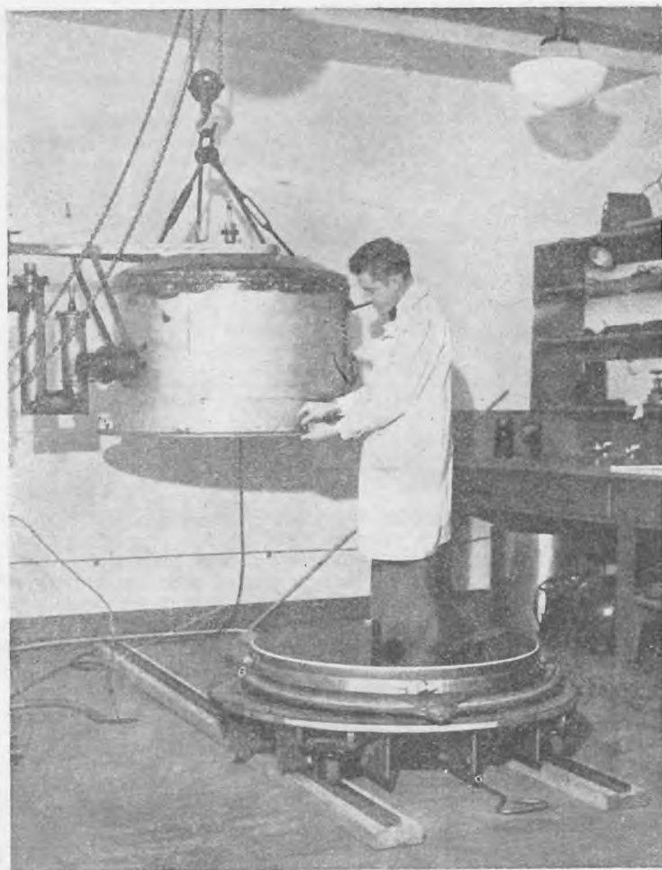
Dr John Strong s přístrojem k pohliníkování zrcadla Crossley reflektoru.
