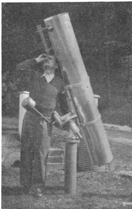
Amatérský reflektor Josefa Vicha v Be- nešově u Seml. Průměr zrcadla 260 mm, ohnisko 204 cm.
