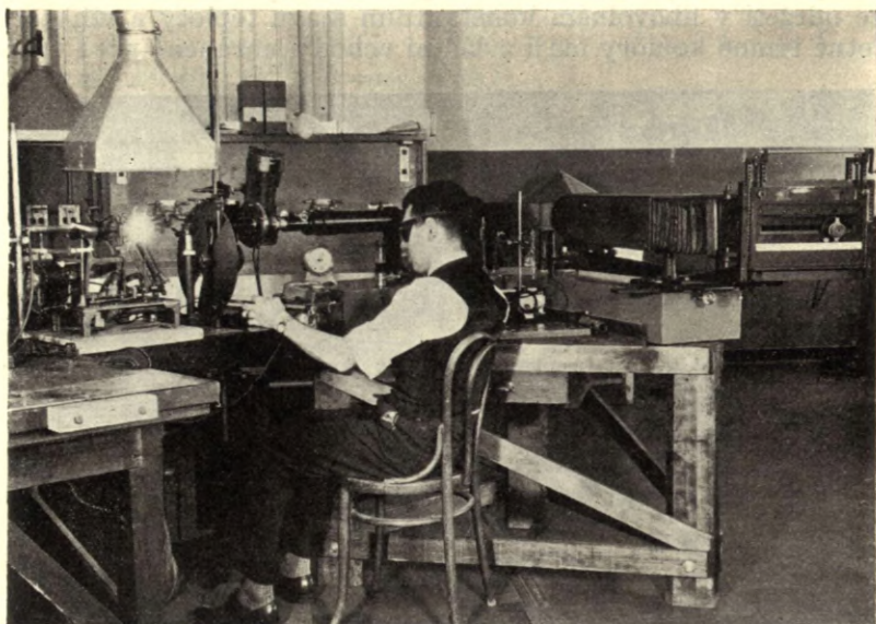
Spektrograf pro infračervené paprsky ve fyzikálním oddělení. Tohoto přístroje se používá při zkoumání desek, citlivých k infračerveným paprskům a vyráběných laboratoří pro účely hvězdářské a spektrografické.
