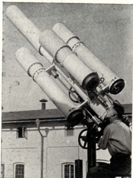
Refraktor typu „medial“ s třemi fotografickými komorami, konstruovaný panem Ed. Rolfem v Chotěvích u Hostinného.
